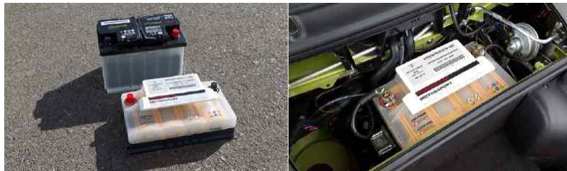
[左. 포르쉐 차량에서 기존에 사용하던 납산배터리와 최근 개발된 Li배터리] [右. 기본옵션으로 포르쉐에 장착된 Li배터리]
