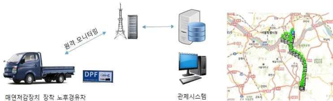
[그림] 전체 시스템개요(좌) 및 관제시스템 이동경로 예시(우)
