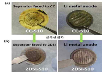
(2) 본 기술의 일 실시예 및 비교예에 의하여 제조되는 리튬-황 이차전지의 분리막 및 리튬 메탈부분을 나타냄
