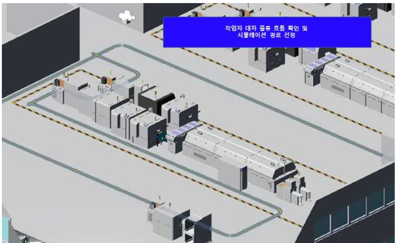
[그림.2] 공장 Digital Twin 구현 시 대차 경로에 대한 데이터 활용의 예
