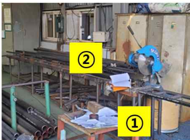
그림) PIPE 절단 공정 전 자재 인식 및 마킹 공정(작업자 수동 작업)
