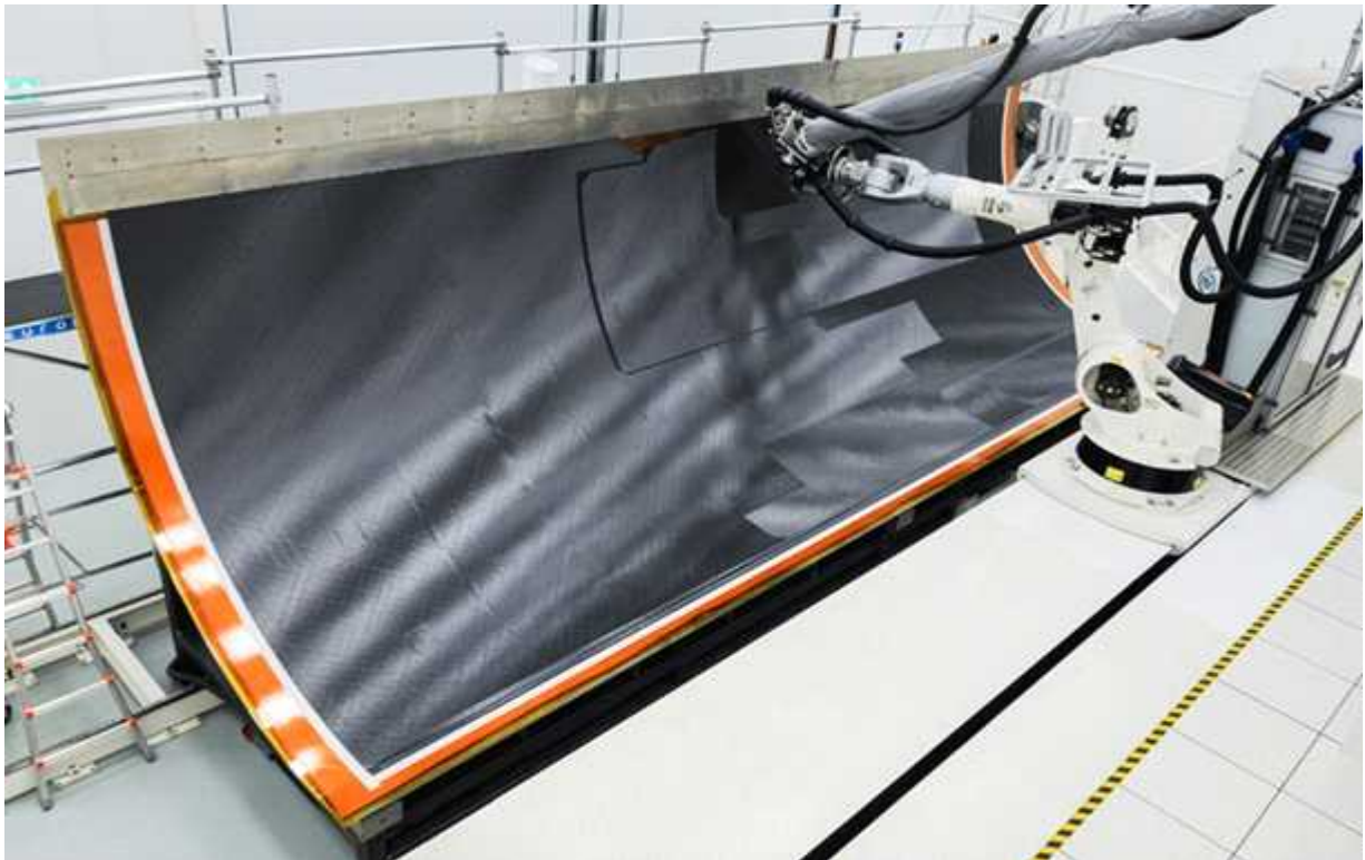
* 다관절 로봇을 적용한 복합재 소재의 항공기 동체 파트 생산(예시)
