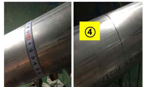
그림) PIPE 절단 공정 전 자재 인식 및 마킹 공정(작업자 수동 작업)
