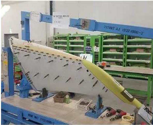
* 드릴링 공정이 적용되는 항공기 Raked Wing Tip(예시)
