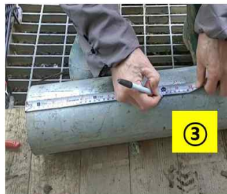
그림) PIPE 절단 공정 전 자재 인식 및 마킹 공정(작업자 수동 작업)
