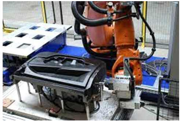
* Cured Laminate Trimming 확대적용 가능한 타 산업분야 적용예시
