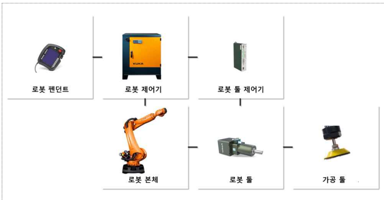
[ 제조로봇을 활용한 Core Beveling &amp; Sanding 공정 구성 ]
