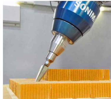
* 항공기에 사용되는 다양한 복합소재 및 Honeycomb Core 절단공정 사용 예시
