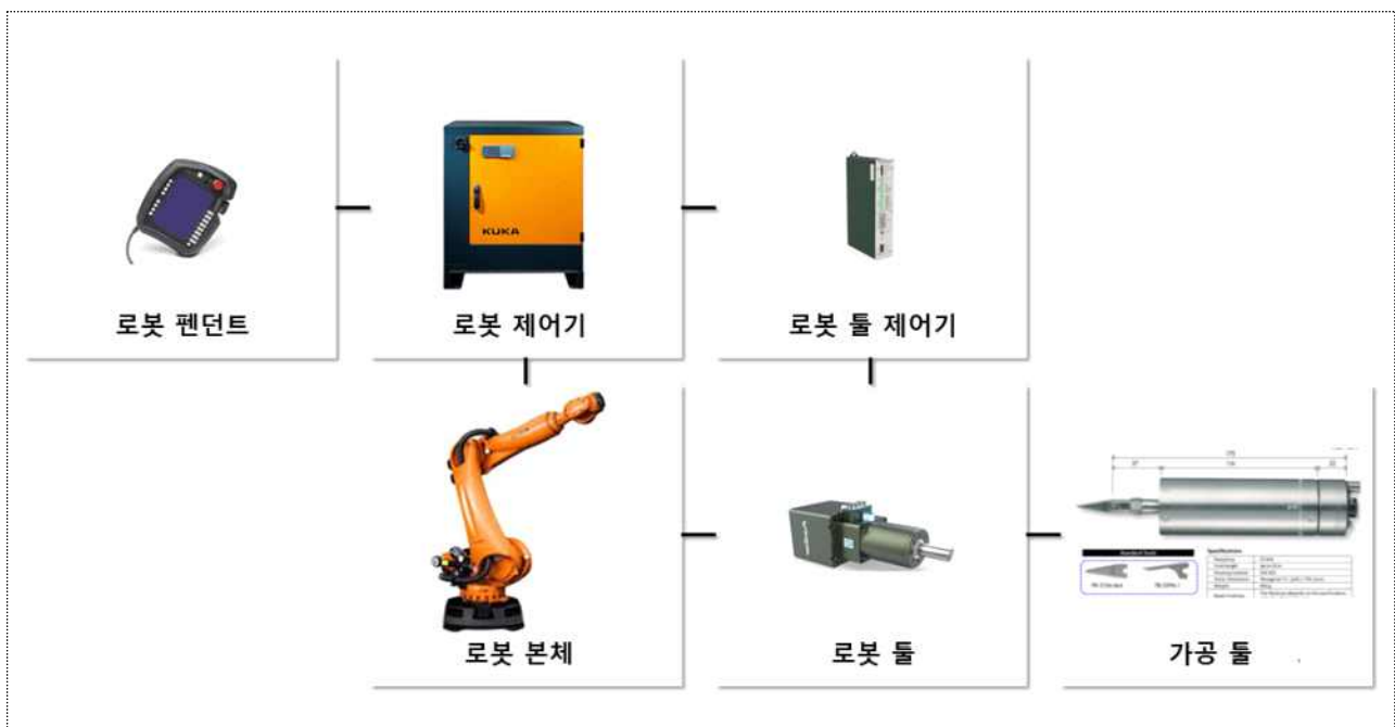
[ 제조로봇을 활용한 Prepreg Charge Trimming 공정 구성 ]
