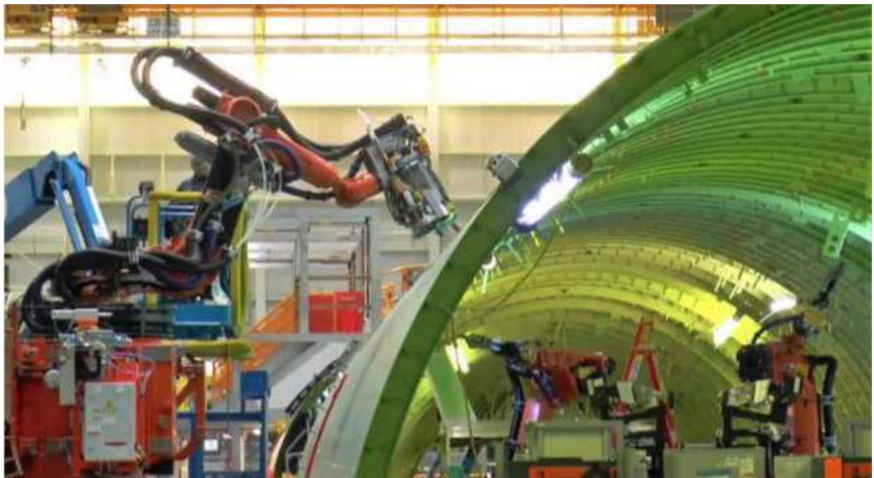
* 다관절 로봇을 적용한 항공기 드릴링 공정(예시)
