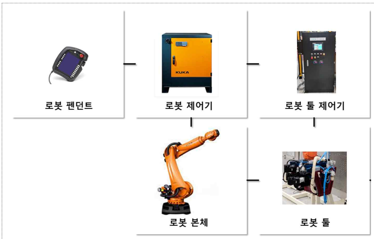
[ 제조로봇을 활용한 평판 Riveting 공정 구성 이미지 수정 ]
