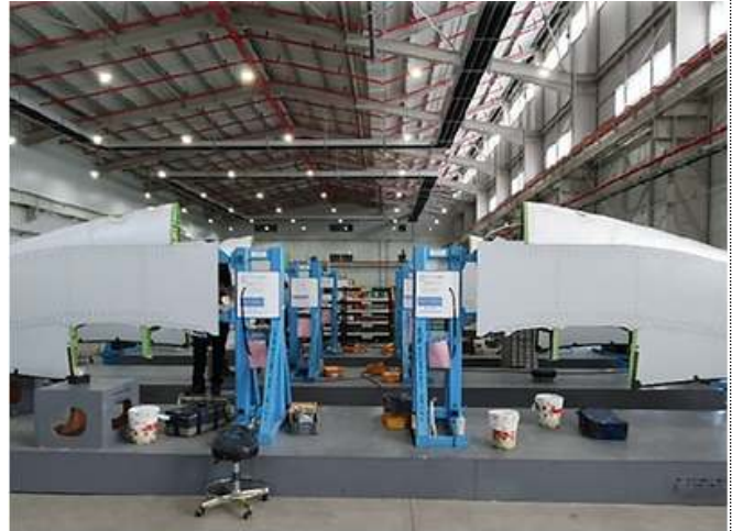
* 드릴링 공정이 적용되는 항공기 Raked Wing Tip(예시)
