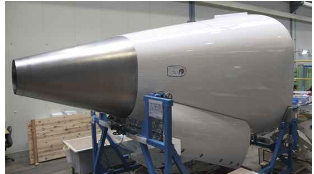
* Firewall 이 장착된 항공기 Afterbody 사진 예시
