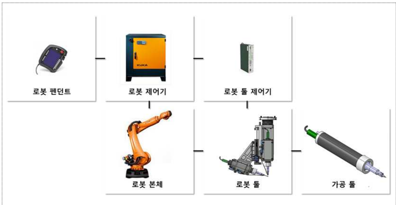
[ 제조로봇을 활용한 Prepeg Charge Trimming 공정 구성 ]?
