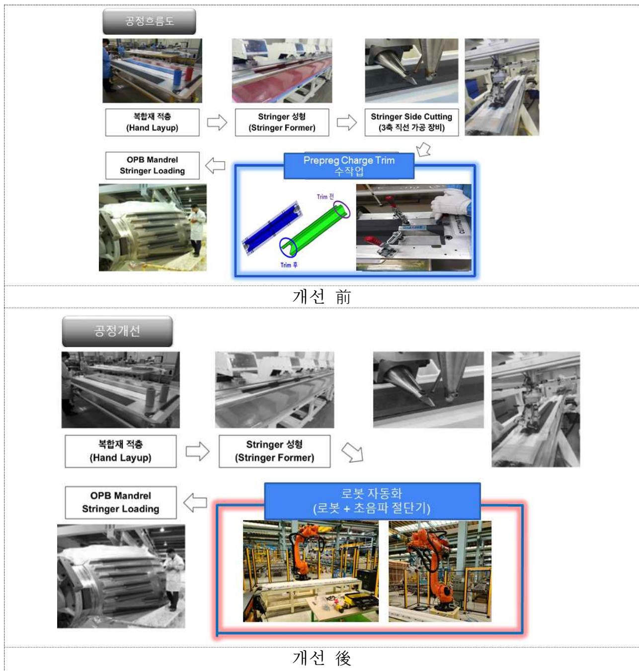
[ Prepreg Charge Trimming 표준모델 도입 공정 흐름도 ]
