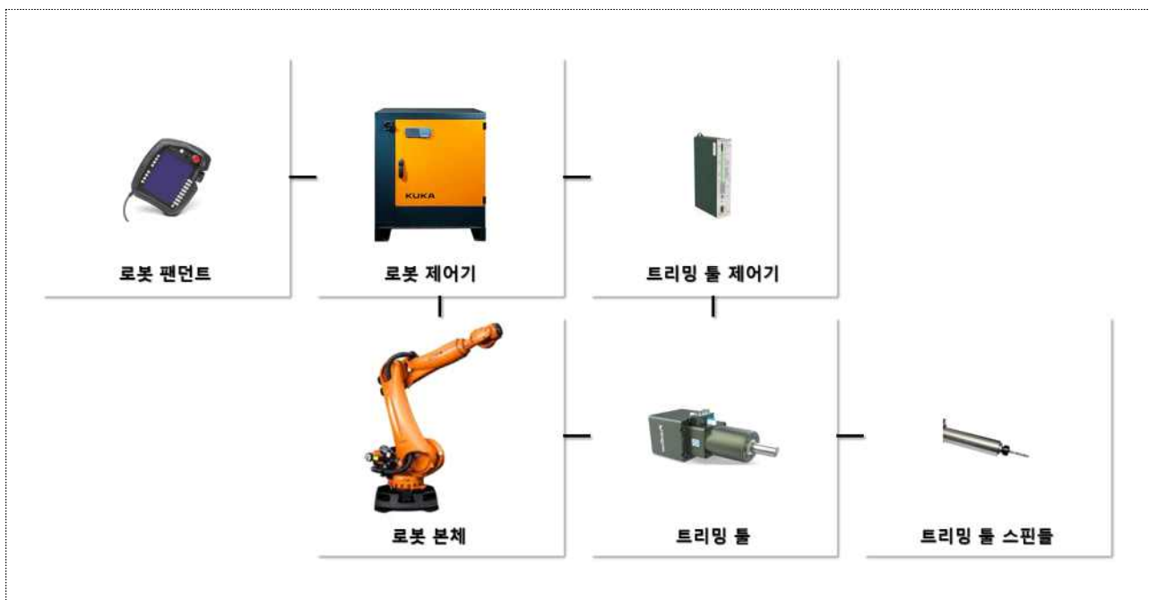
[ 제조로봇을 활용한 Cured Laminate Trimming 공정 구성 ]
