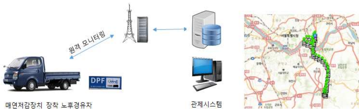
[그림] 전체 시스템개요(좌) 및 관제시스템 이동경로 예시(우)
